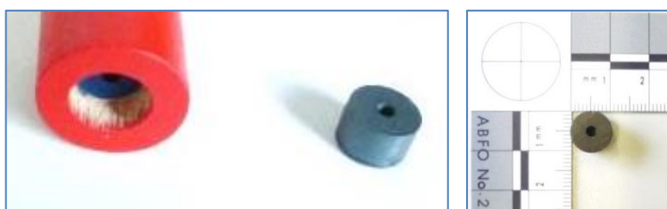
Abbildung 4: Holzspielzeug, eingeklebter Ringmagnet hat sich bei der Fallprüfung herausgelöst und passt vollständig in den Zylinder für kleine Teile und hat einen Flussindex von >100 \text{ kG}^2\text{mm}^2
