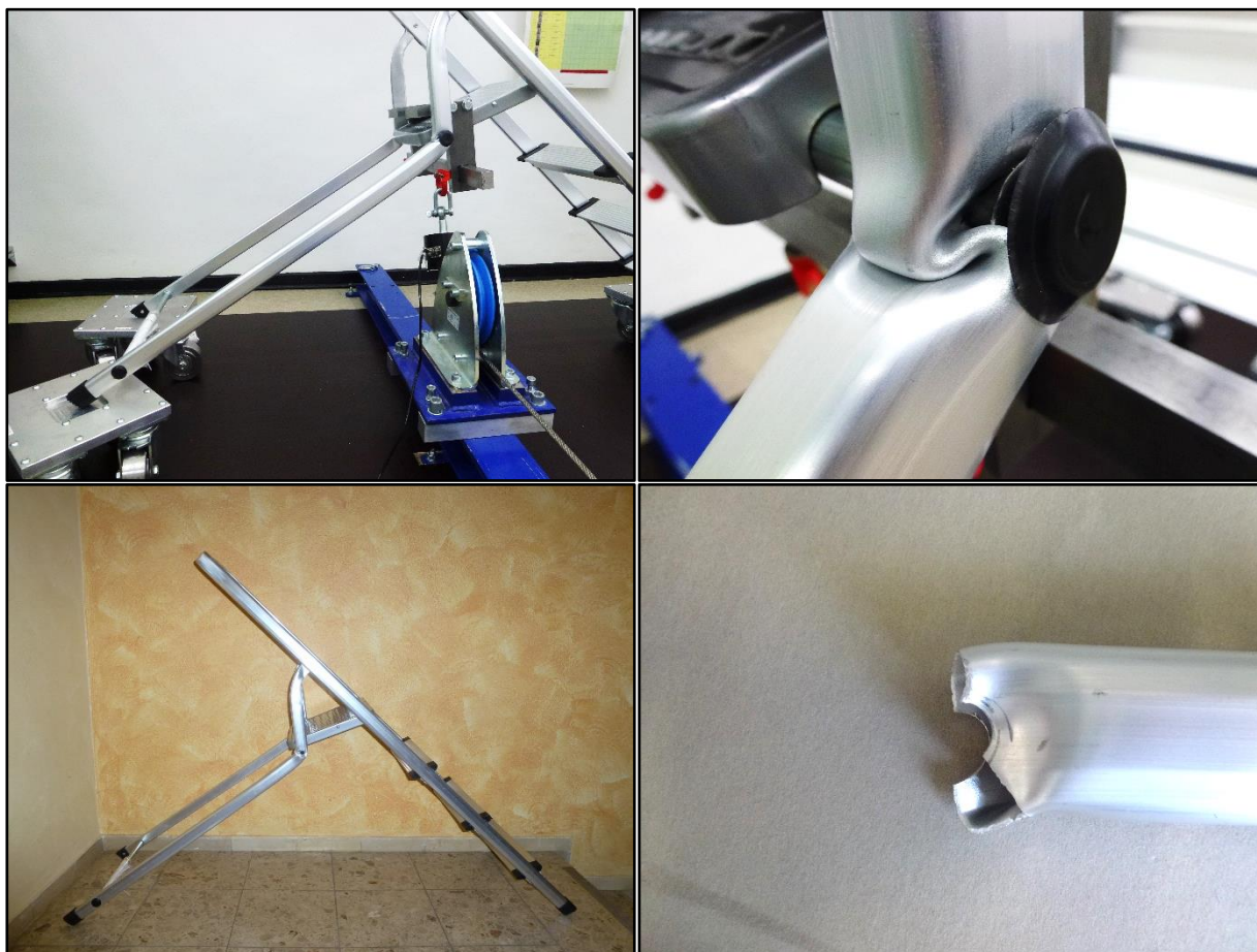
Abbildung 8: Defekte Leiter nach Belastungsprüfung
