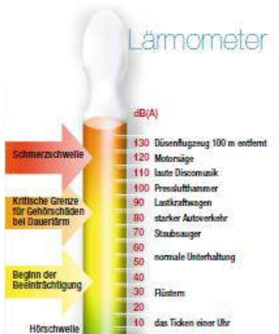
Abb.2 „Lärmometer“ (verschiedene Schallereignisse und deren Schalldruckpegel) [Quelle: Online- Informationsbroschüre des Amtes für Luft und Lärm, Bozen]
