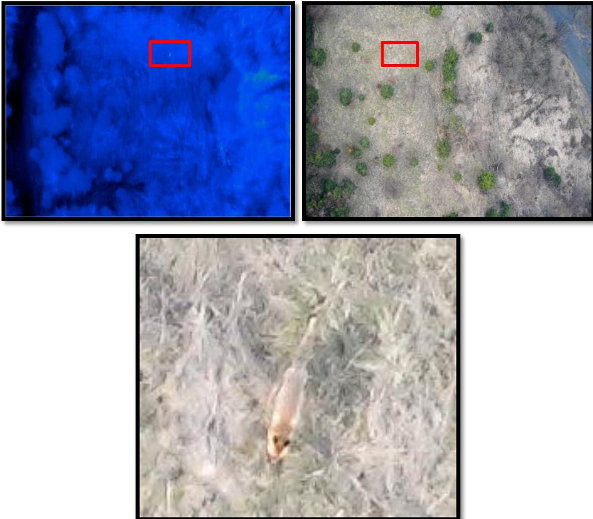
Je kleiner das Tier, desto weniger Pixel (Bildelemente) bilden es ab. Im Wärmebildbereich wird hier mit einer Auflösung von etwa 10 cm / Pixel geflogen. Damit können auch kleinere Tiere wie Füchse und teilweise Hasen detektiert werden. Obiges Beispiel zeigt ein Fuchs im Offenland.
